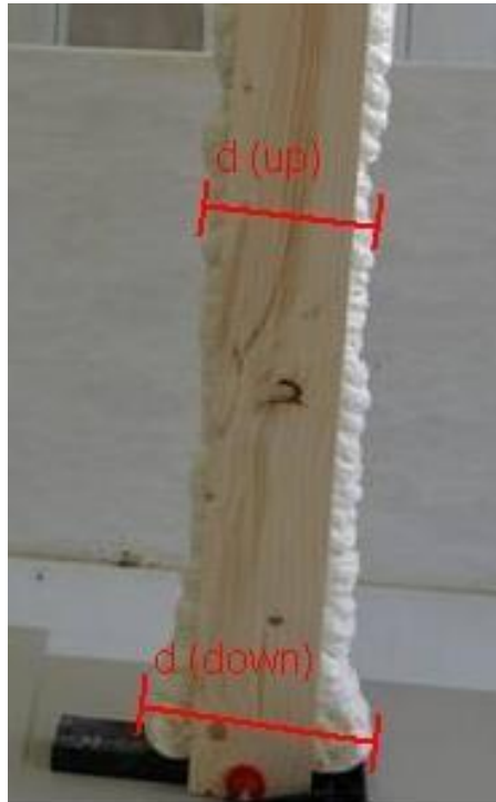
Фото 4: Образец частично провисшей пены
