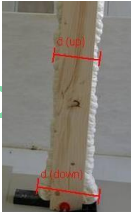
Фото 4: Образец частично провисшей пены
